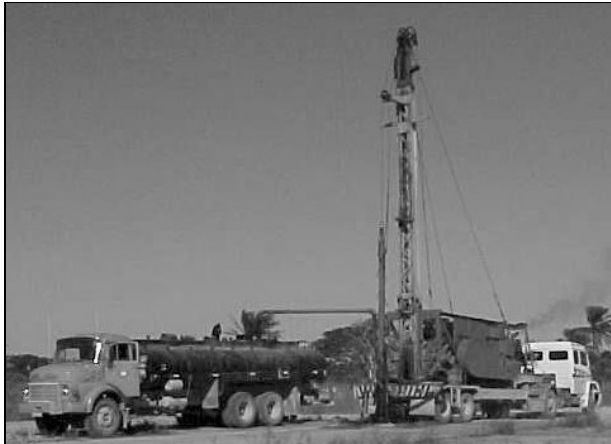
Figura 2.1: Uma UMP acoplada a um caminhão tanque.
