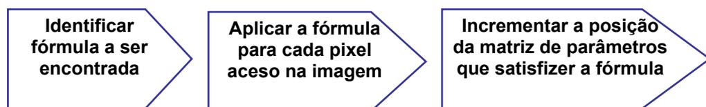
**Figura 1.1-** Etapas da aplicação da transformada de Hough para qualquer forma geométrica.
