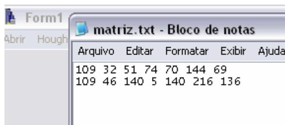
**Figura 3.19-** Dados da vetorização do teste 7. Respectivamente: coordenadas **x** e **y** do centro, raio, e pares de pontos iniciais e finais dos arcos.
