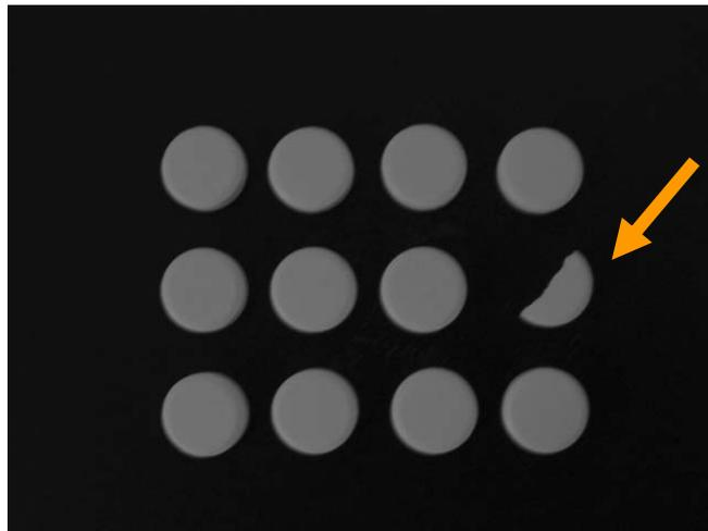
**Figura 5.15**-Imagem original de pílulas de forma circular, onde uma apresenta falha
