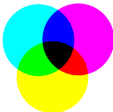
Figura 2.15: Processo subtrativo de cores do espaço CMY .
