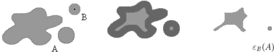
Figura 1.12: Erosão do conjunto A pelo EE B .
