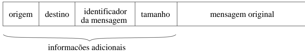
Figura 3.4: Mensagem gerada pelo MEGMPI_Send() após concatenar informações à mensagem original da aplicação.
