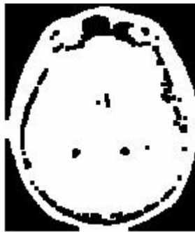
Figura 28: Fechamento com Elemento Estruturante Quadrado 3x3
