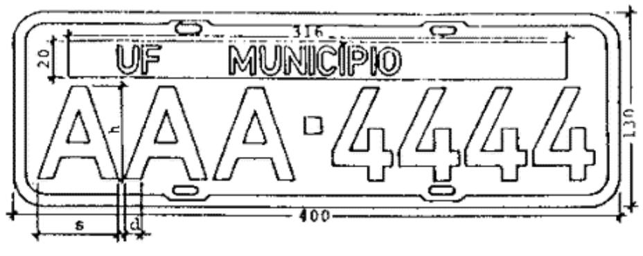
Figura 27. Forma e dimensões da placa em mm (CONTRAN, 2006).
