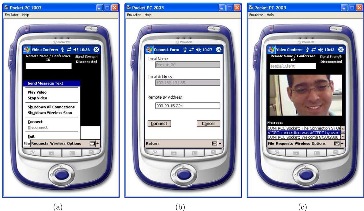
Figura 5.8: Imagens do aplicativo cliente, no *Pocket PC*: (a) *Menu File*; (b) Formulário de conexão com o aplicativo servidor; (c) Vídeo no dispositivo.
