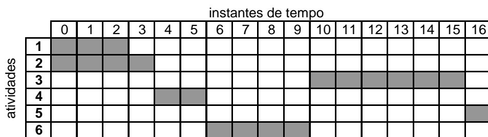
Figura 2 - Gráfico de Gannt de uma possível solução à rede de projeto da figura 1
