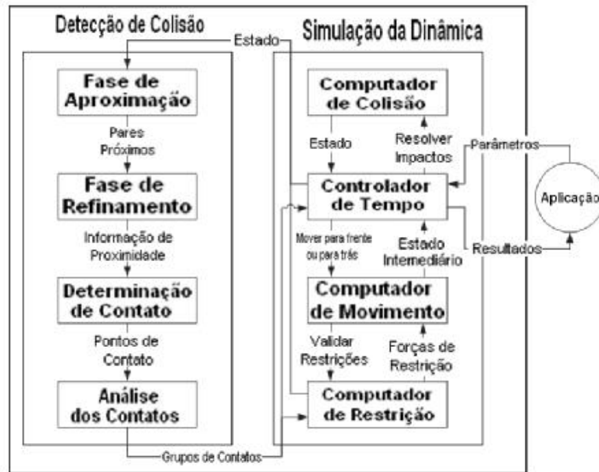
Figura 5: Funcionamento de um motor de física de corpos rígidos.
