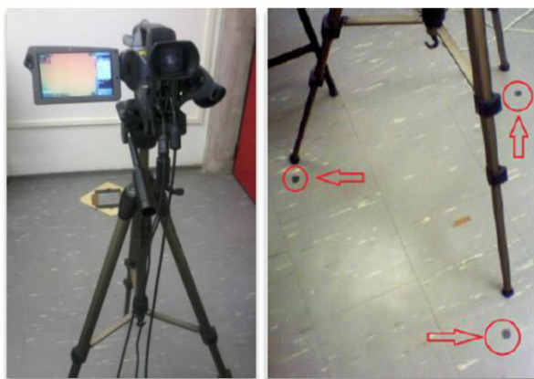
Figura 2.4: Câmera fixada no tripé posicionado no local indicado [77].
