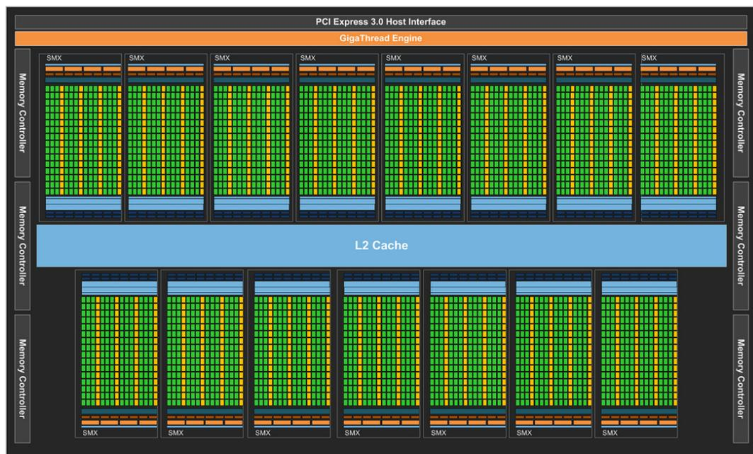
Figura 3.1: Arquitetura das placas baseadas na arquitetura Kepler da NVidia
